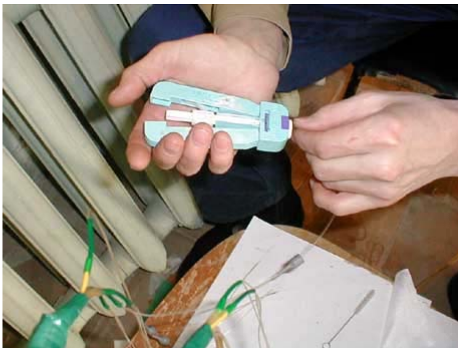
Рис. 3.7. Снятие буфера с волокна.
