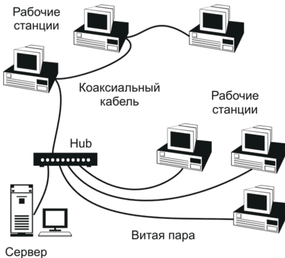
Рис. 2.2. Схема "классического Ethernet"
