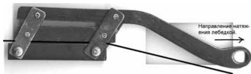
Рис. 1.69. Приспособление для натяжения проволоки или троса.
