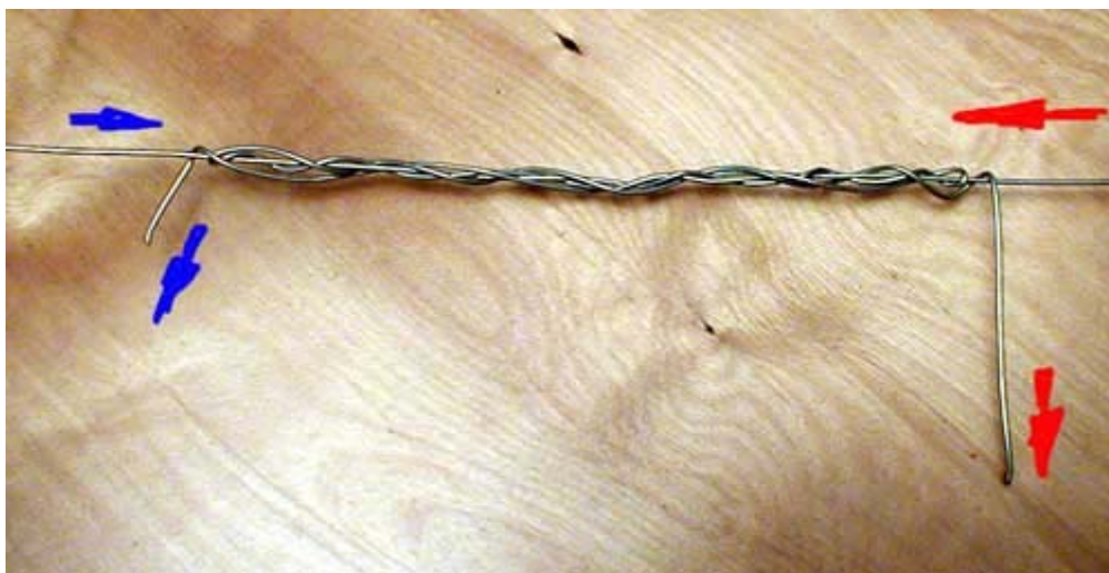
Рис. 1.45. Скрутка перед закреплением концов.
