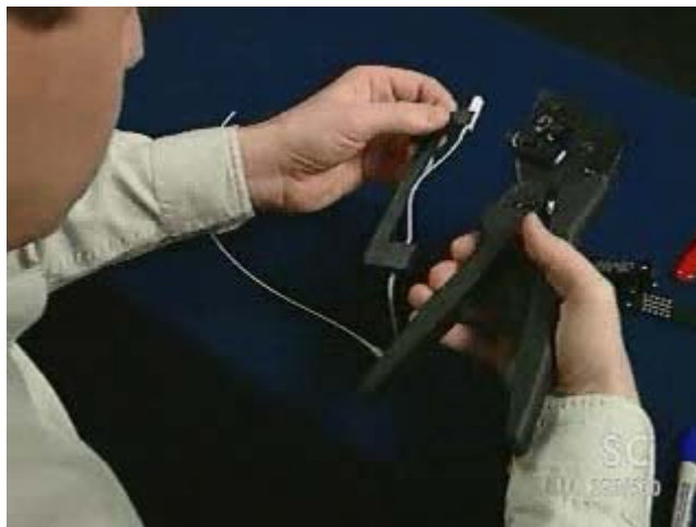
Рис. 3.24. Обжим Light Crimp Plus.
