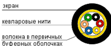
Рис. 3.1. Кабель в плотном буфере.
