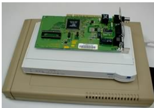
Рис. 6.1. Смена поколений. Хаб Zcom Office connect и адаптер Zcom 900 в масштабе со старым модемом.
