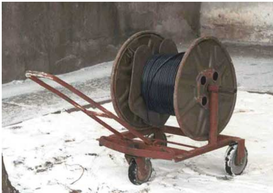
Рис. 1.74. Приспособление для перевозки и размотки П-296/П-270.
