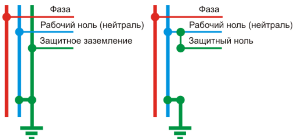
Рис. 4.5. Отличие защитного заземления и защитного "нуля"
