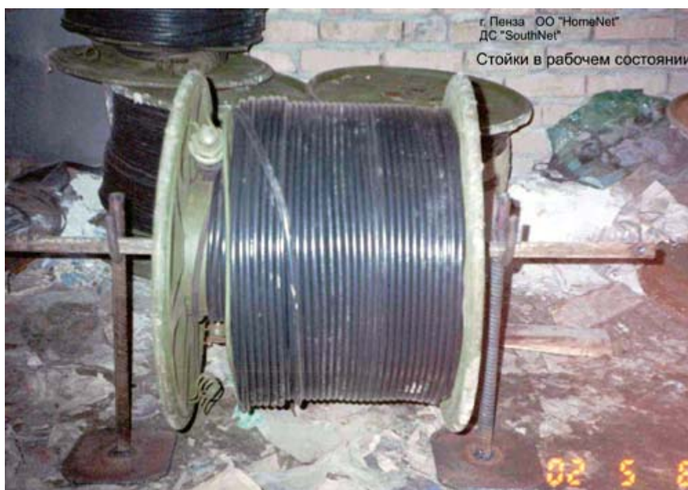
Рис. 1.73. Приспособление для размотки П-296/П-270.
