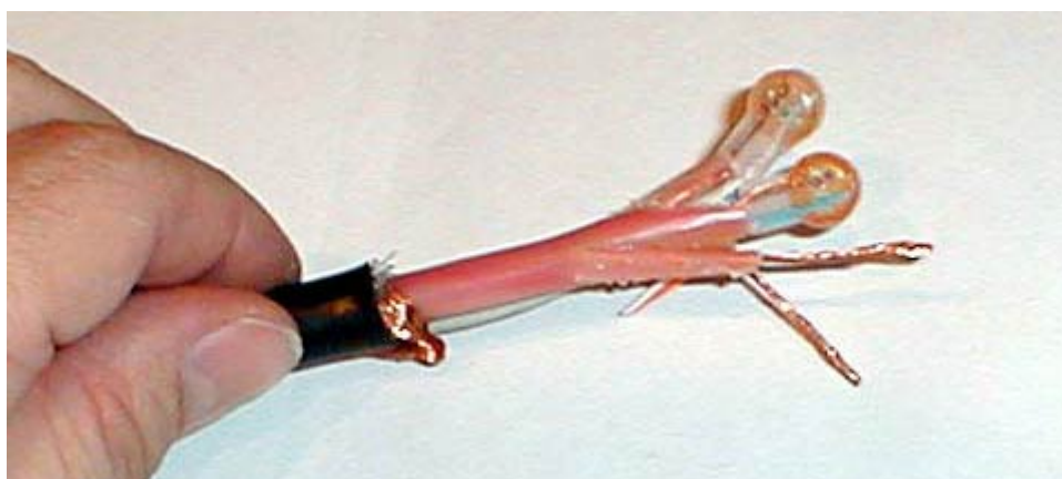
Рис. 1.66. Соединение П-296 с витой парой при помощи Scotchlok.
