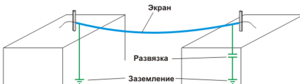
Рис. 4.9. Заземление экрана кабеля.
