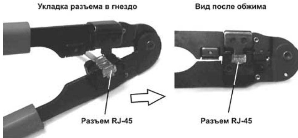
Рис. 5.5. Обжим разъема RJ-45.
