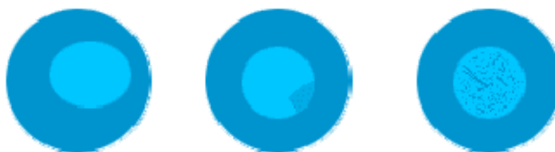
Рис. 3.14. Виды дефектов. Слева направо: перекоп, глубокий скол, недостаточно обработанный торец.
