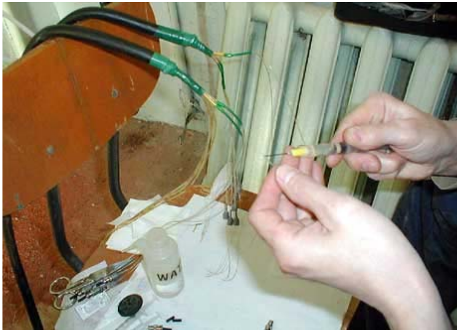
Рис. 3.9. Нанесение клея на волокно.
