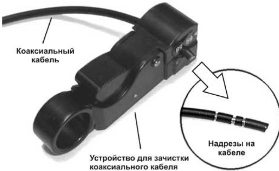
Рис. 5.9. Надрезание изоляции коаксиального кабеля
