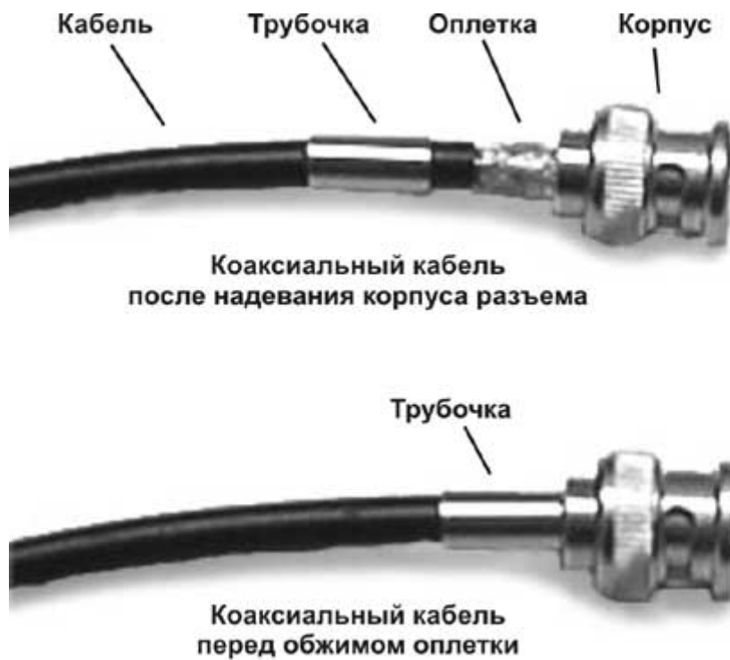
Рис. 5.12. Разъем перед обжиманием оплетки.
