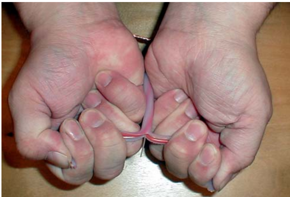
Рис. 1.60. "Разрывание" центрального блока вдоль сделанного надреза.
