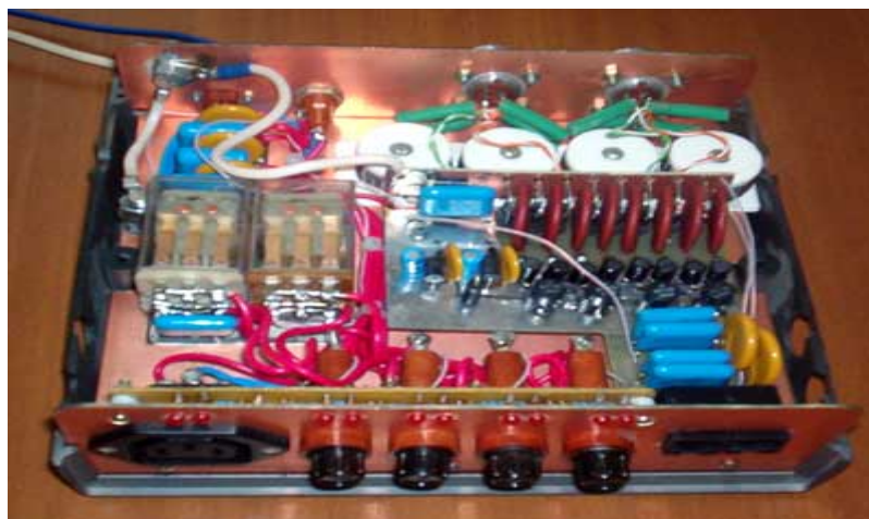
Рис. 1.72. Фантомное питание переменным током.
