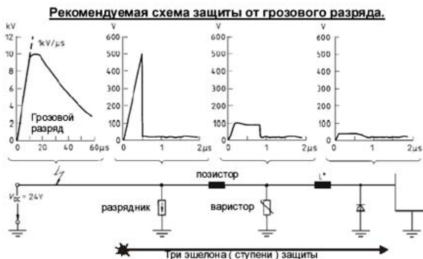
Рис. 4.14. Схема грозозащиты с варистором. Минусы - стоимость (10 рублей варистор, а их нужно 4), и сравнительно низкая мощность (могут сгореть даже с дополнительным ограничителем напряжения или разрядником). Как не мала на первый взгляд стоимость в 40 рублей - реально это заметно удорожит итоговую стоимость изделия.
