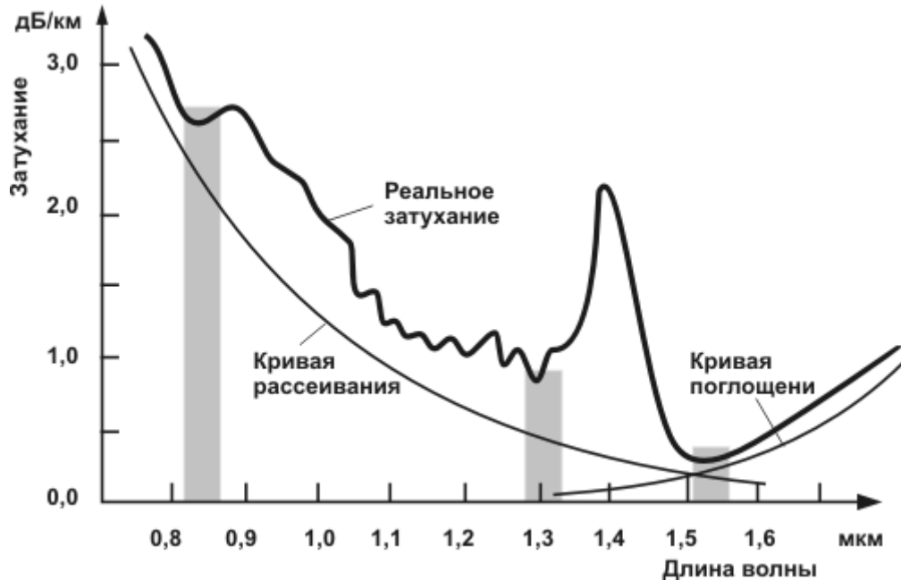
Рис. 8.2. Окна прозрачности оптических волокон
