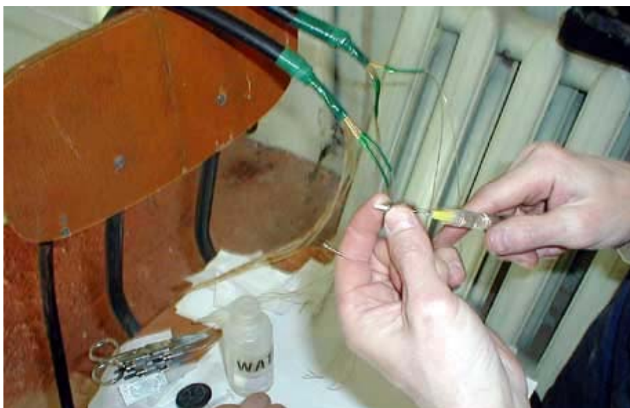
Рис. 3.8. Нанесение клея на коннектор.
