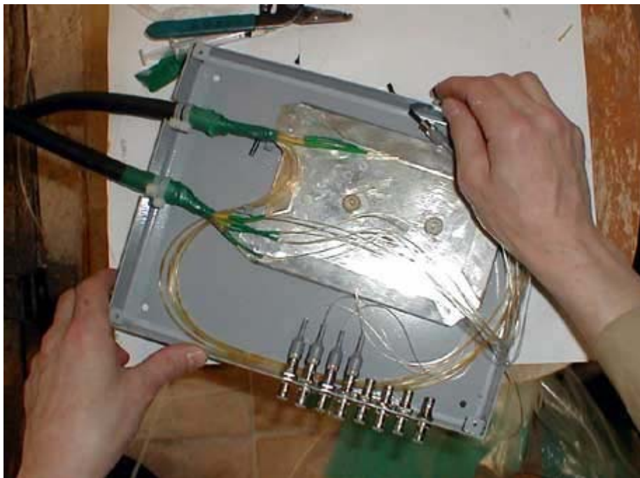
Рис. 3.16. Укладка в коробку.
